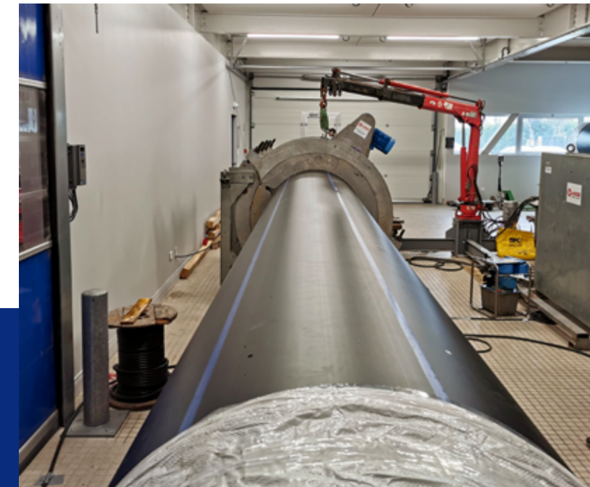
Tuyaux en polyéthylène haute densité qui remplaceront, sur les EPR2, les galeries béton enterrées du circuit d'eau brute secourue.
